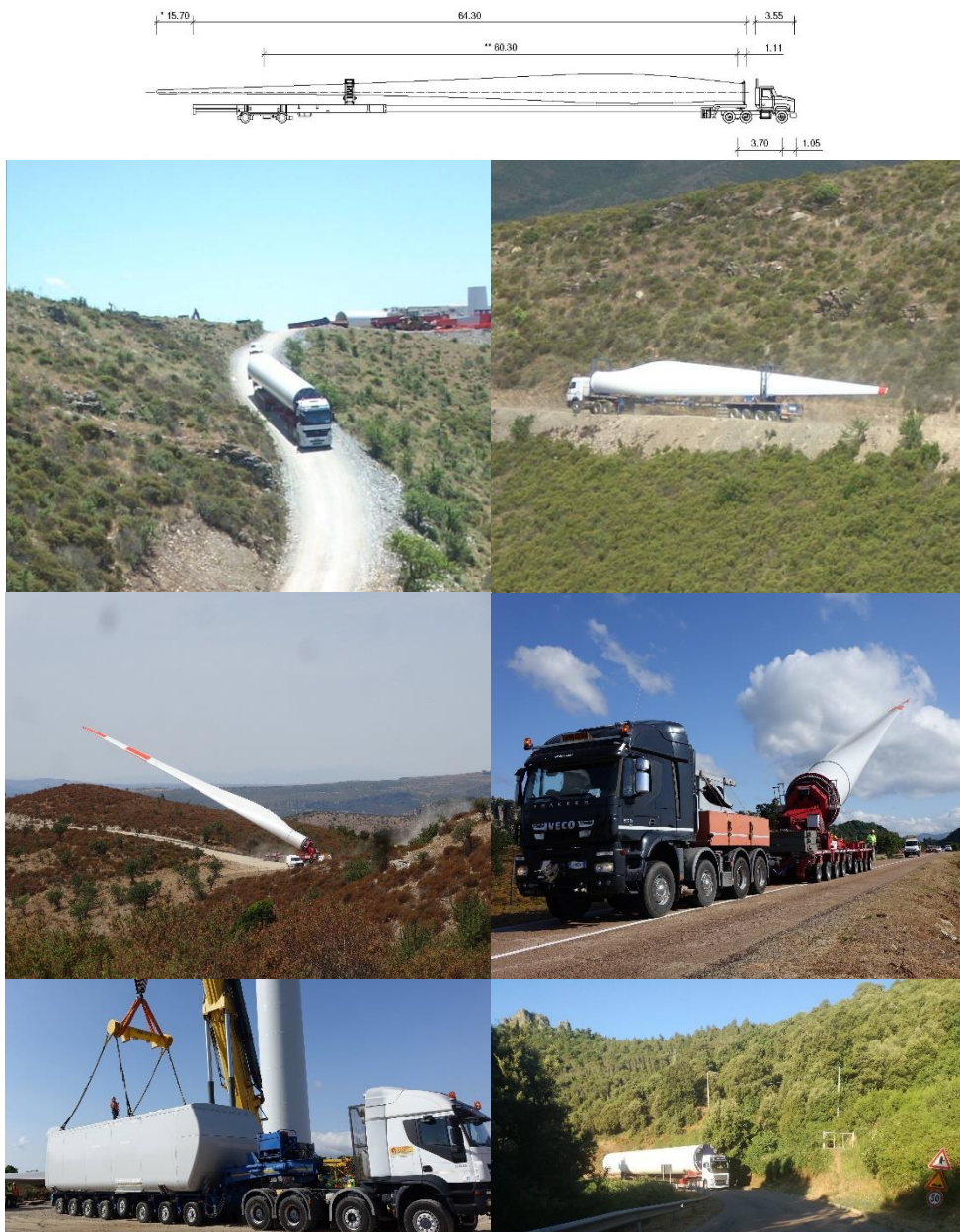
Figura 8: realizzazioni tipiche di strade per parchi eolici.
