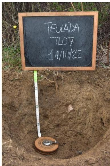
Il sito scelto per l'installazione dell'aerogeneratore TL07 è ubicato morfologicamente nella parte mediana di un rilievo collinare, prossimo ad un piccolo deposito eluvio-colluviale, a quota di 349m s.l.m. A differenza delle altre stazioni precedentemente descritte questa ricade geologicamente nel complesso intrusivo granitoidale dell'Unità di Villacidro al confine con il Membro di Matoppa.
