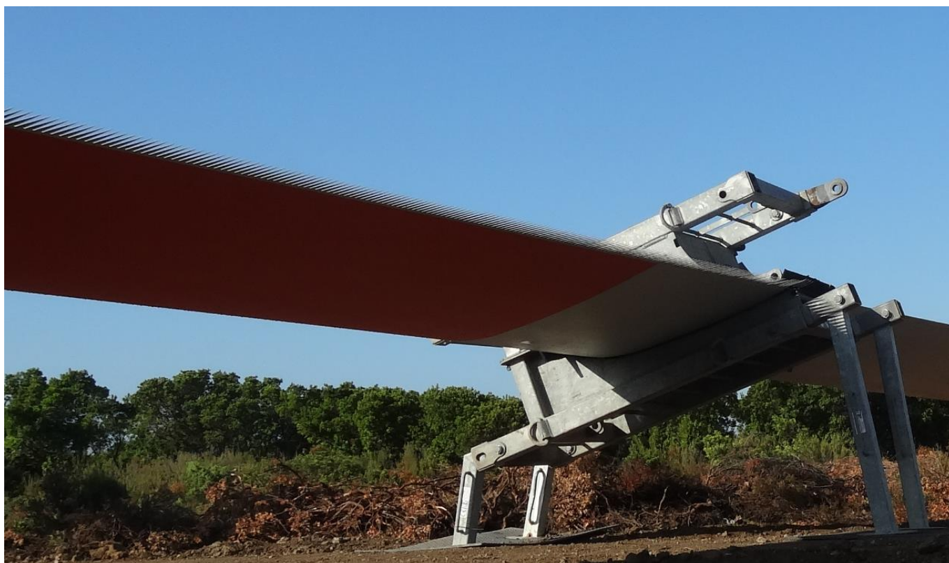
Figura 7 Pala di aerogeneratore con bande dentellate
