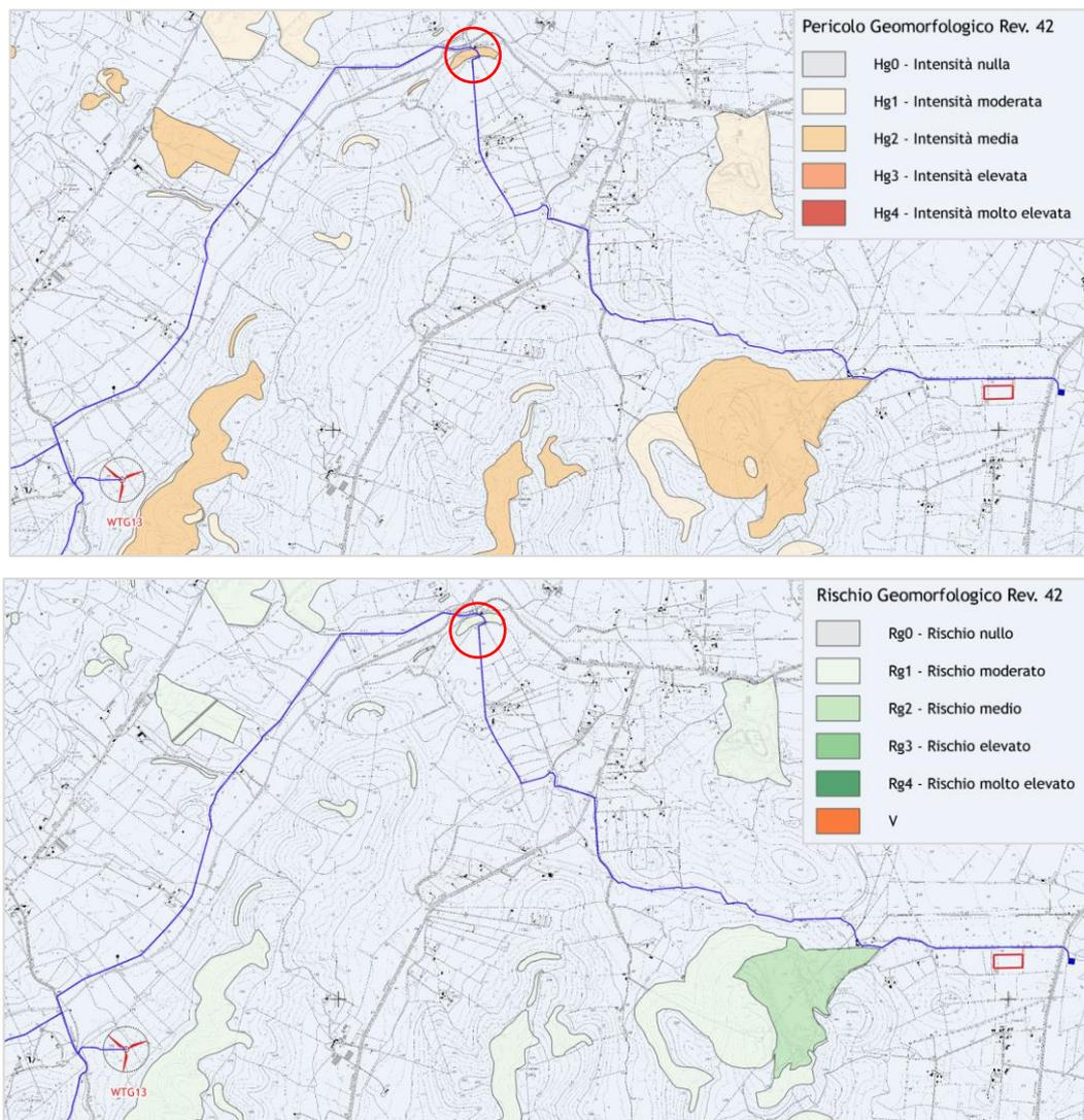
Figura 15. Pericolosità e rischio geomorfologico con individuazione del punto di interferenza con il cavidotto.
