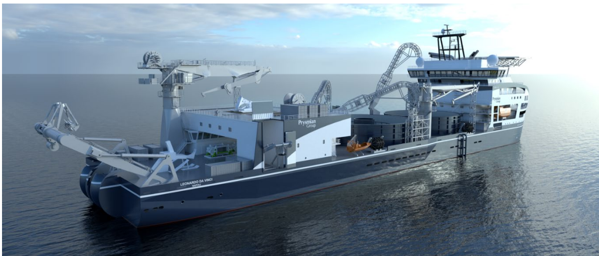
Figura 3:13: Nave posa cavo Leonardo Da Vinci (Fonte: Prysmian Group/Fincantieri)
