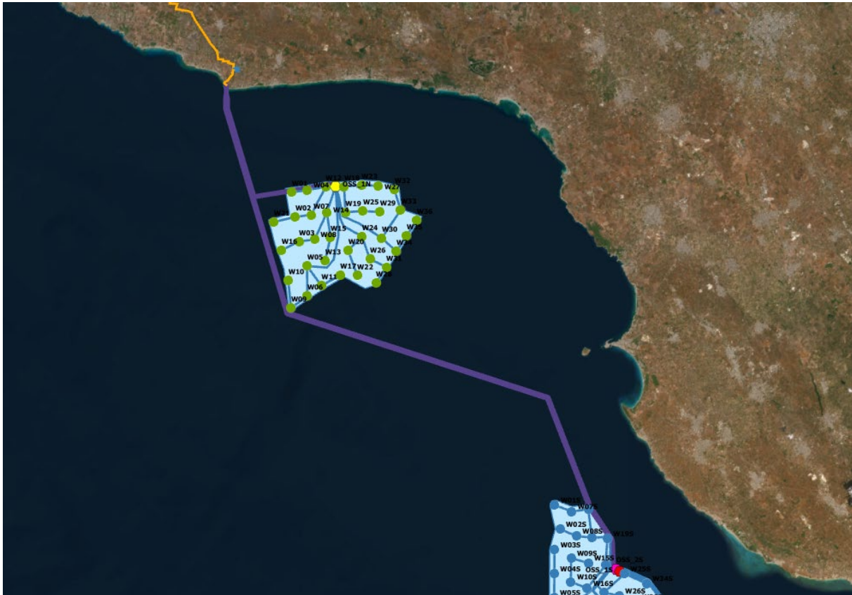
Figura 3:4: Vista complessiva del corridoio dei cavi marini a 380 kV –
