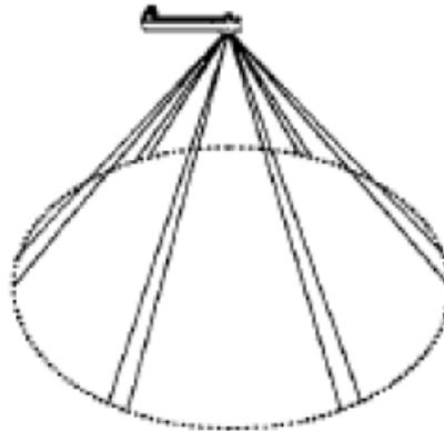
Figura 4.4: Sistema di Ormeggio a Elementi Tesi [1]
