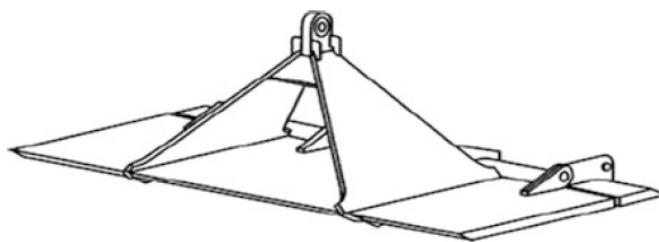
Figura 5.8: Esempio Schematico di Ancora a Piastra [4]
