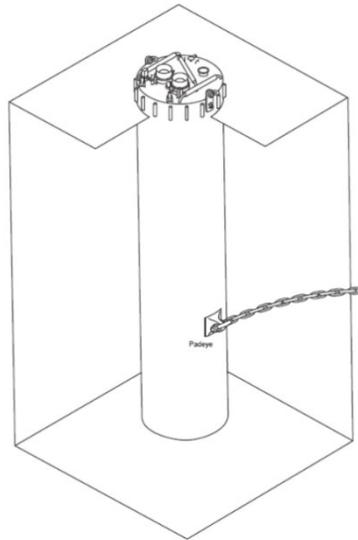
**Figura 5.2: Tipica Connessione tra 'Suction Pile' e Linea di Ormeggio a Catenaria [8]**
