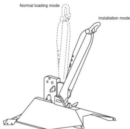
Figura 5.7: Variazione Angolo 'Shank-Fluke' Installazione/Esercizio per Ancora Bruce Dennla VLA [5]
