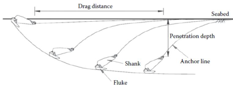
Figura 5.5: Schema di Installazione di Ancore a Trascinamento DEA [24]
