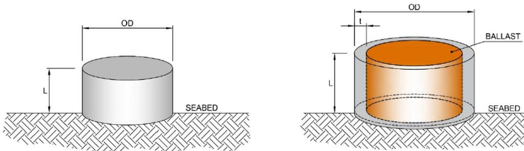
Figura 5.1: Schema Semplicato di Ancore a Gravità Piene (Sinistra) o Cave con Zavorra (Destra)
