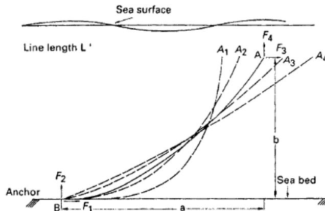
Figura 4.2: Sistema di Ormeggio con Catenaria [1]
