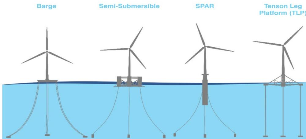
Figura 4.1: Esempi di Strutture Galleggianti per Parchi Eolici
