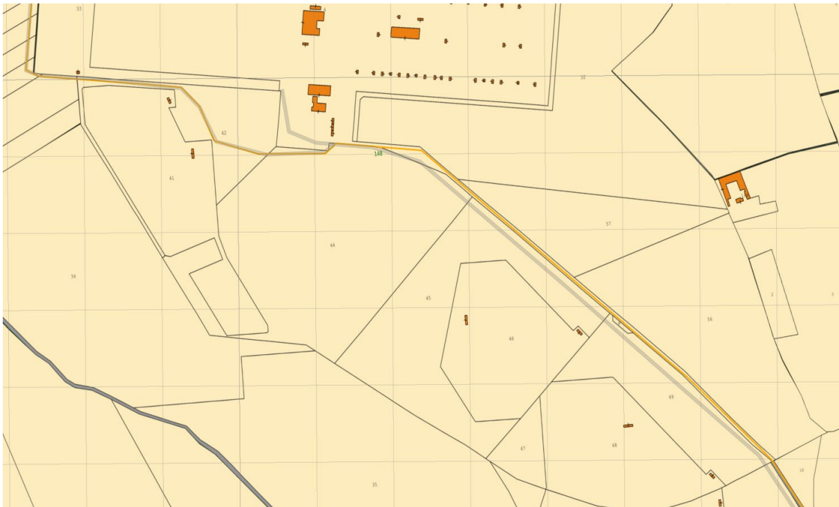
Figura 3:62: cavidotto terrestre su mappa catastale - tratto 52
