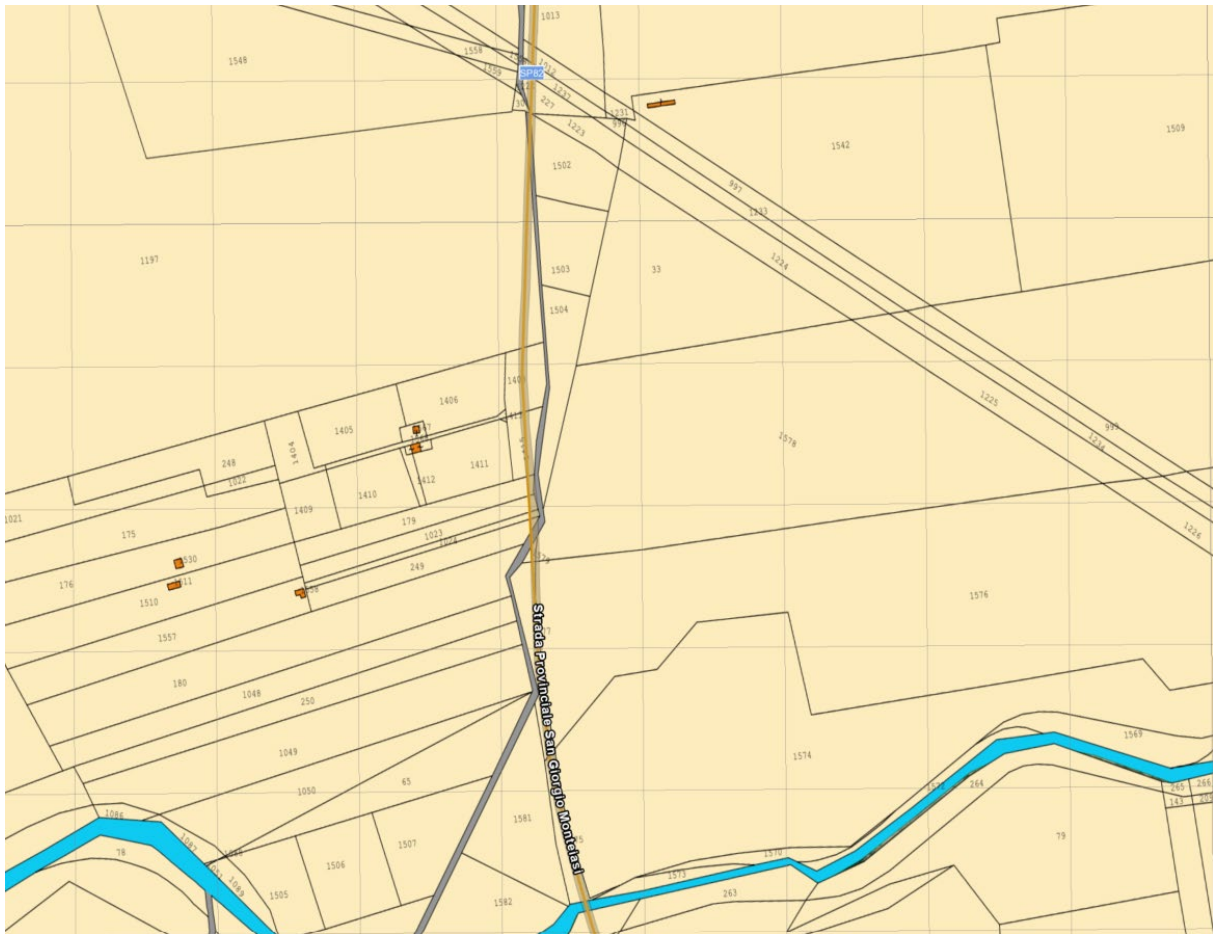
Figura 3:49: cavidotto terrestre su mappa catastale - tratto 41
