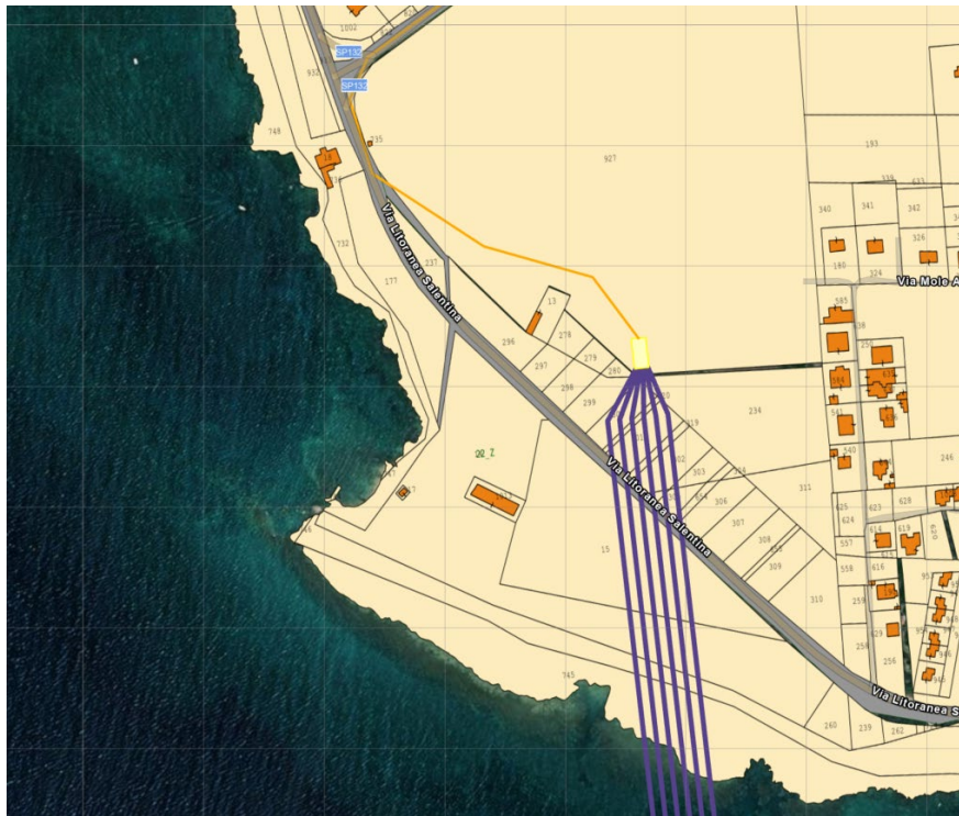
Figura 3:4: cavidotto terrestre su mappa catastale - tratto 1
