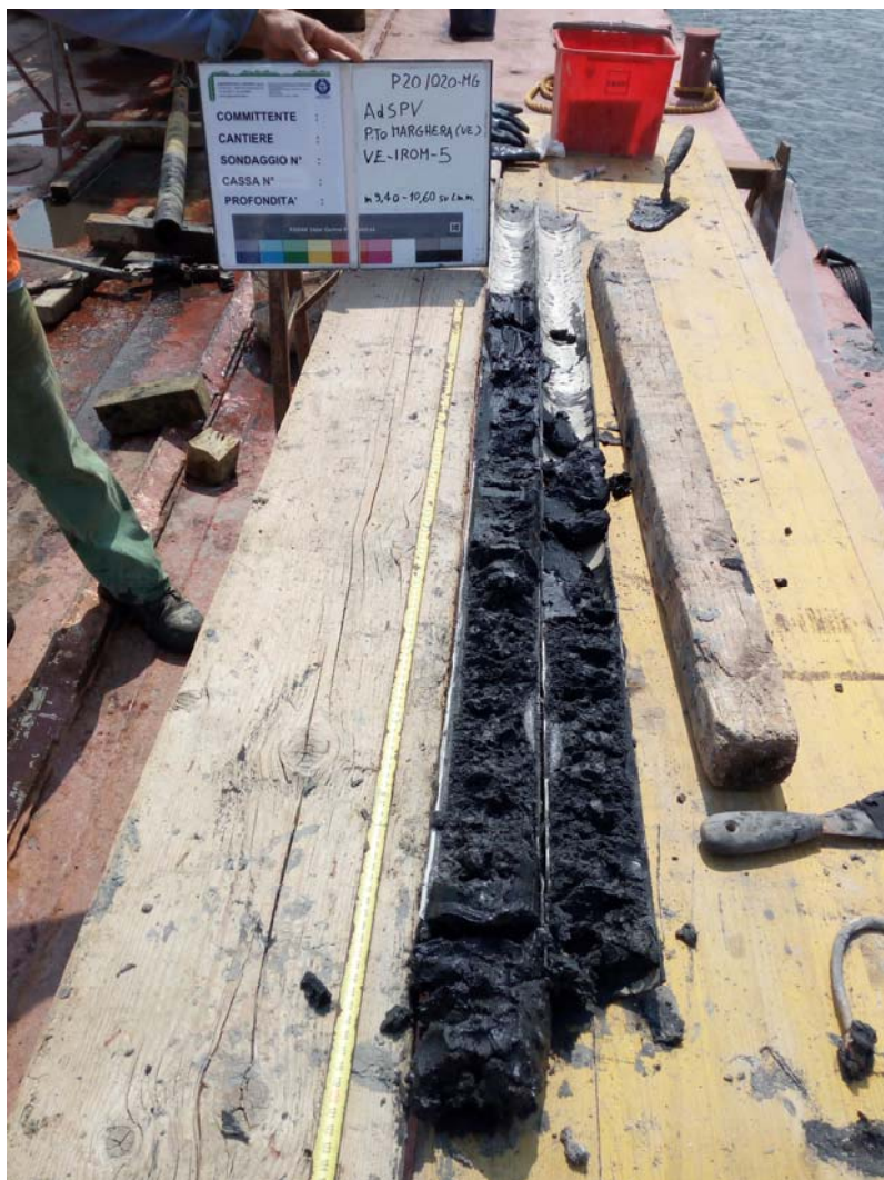
SONDAGGIO N° VE-IROM-5 CAROTAGGIO da m 9,40 a m 10,60
