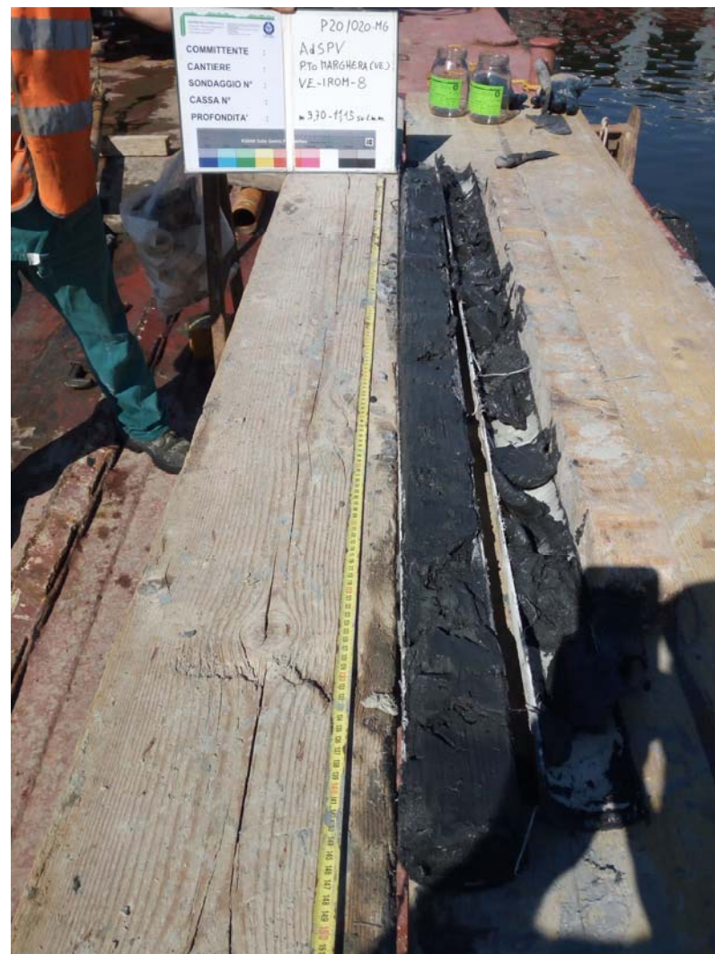
SONDAGGIO N° VE-IROM-8 CAROTAGGIO da m 9,70 a m 11,15
