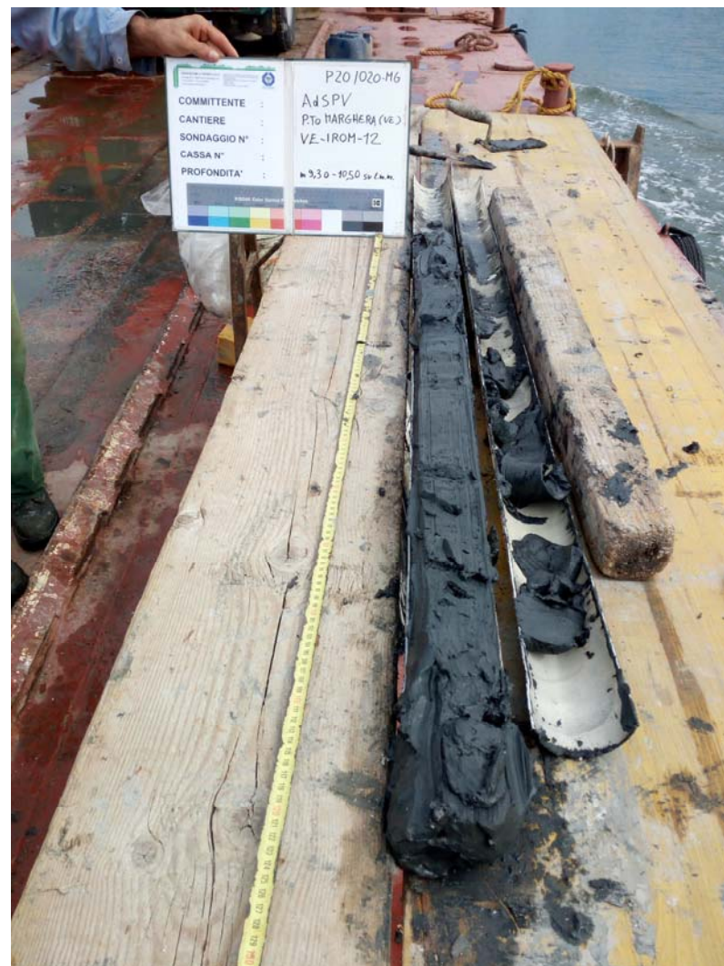
SONDAGGIO N° VE-IROM-12 CAROTAGGIO da m 9,30 a m 10,50
