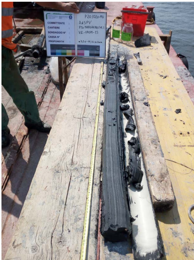
SONDAGGIO N° VE-IROM-15 CAROTAGGIO da m 9,30 a m 10,50
