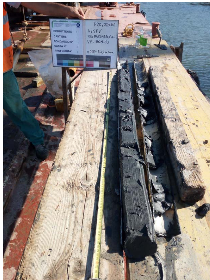
SONDAGGIO N° VE-IROM-10 CAROTAGGIO da m 9,80 a m 11,05
