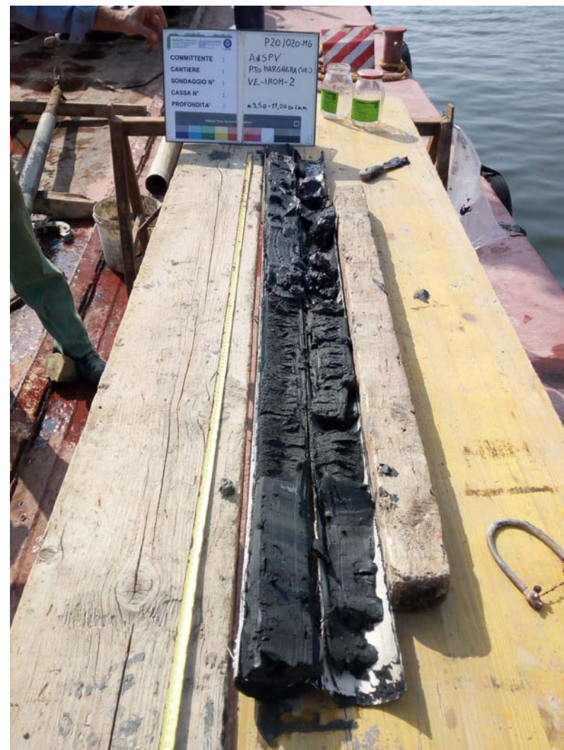
SONDAGGIO N° VE-IROM-2 CAROTAGGIO da m 9,50 a m 11,00
