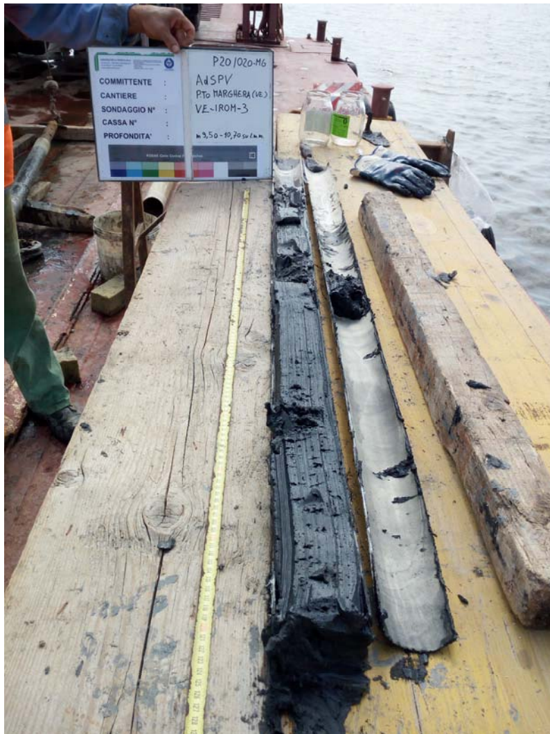
SONDAGGIO N° VE-IROM-3 CAROTAGGIO da m 9,50 a m 10,70
