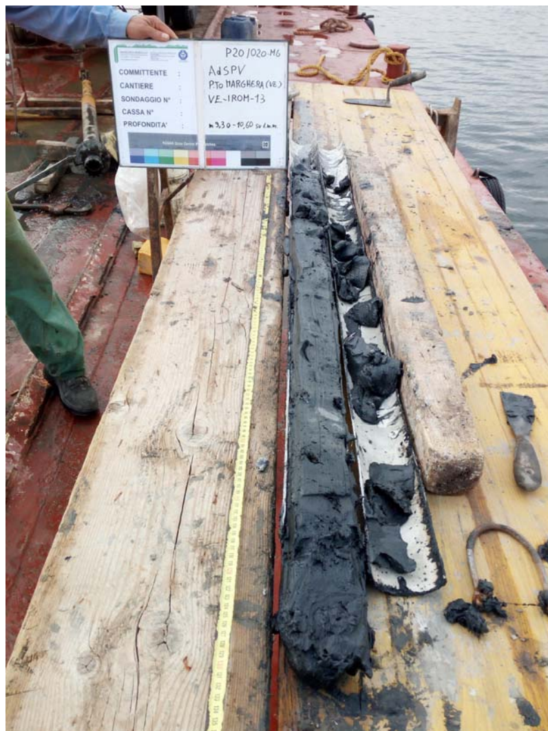
SONDAGGIO N° VE-IROM-13 CAROTAGGIO da m 9,30 a m 10,60
