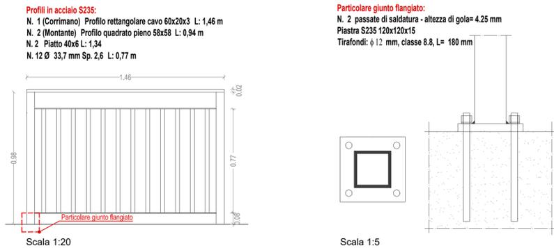
PARTICOLARE COSTRUTTIVO (scala 1:20) - PAVIMENTAZIONE
