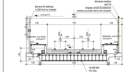
SEZIONE TIPO BANCHINA F.F.P.-Scala 1:100
