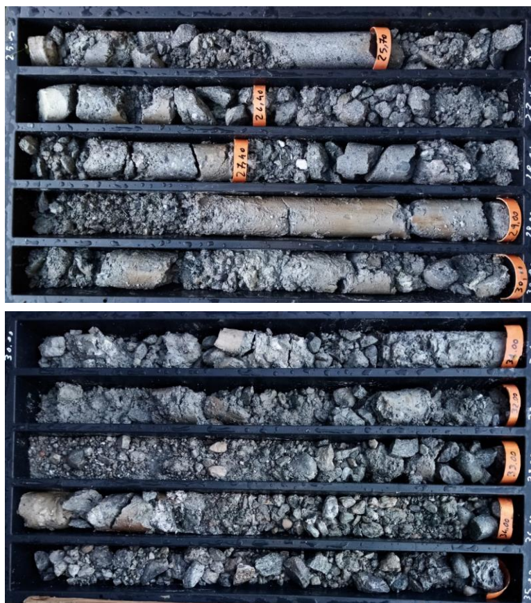
Figura 11. Tratto fortemente fratturato del sondaggio di PE S5 attorno alla pk 8+900, relativo alla quota di passaggio in galleria.
