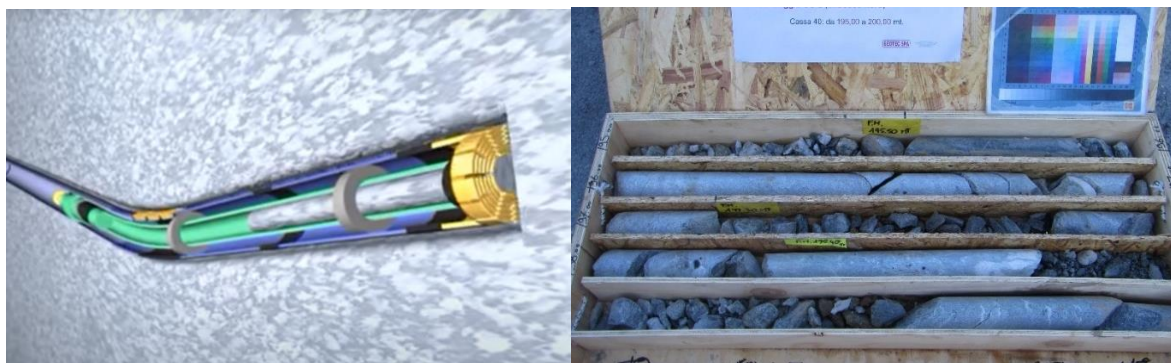
Figura 45 – Schema di carotaggio in orizzontale partendo dal foro deviato realizzato tramite HDD (immagine di sinistra), esempio di carote di sondaggio prelevate con wire-line di diametro HQ.
