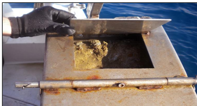
Figura 7-4: Benna Van Veen e setacciatura dei sedimenti su maglie di 1 mm
