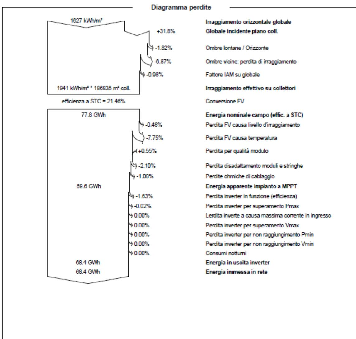
Figura 6: Diagramma riassuntivo delle perdite ottenuto per il progetto in esame con PVSystem
