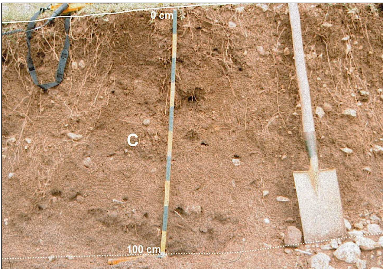
FIGURA 3 – Profilo tipo di regosuolo (WRB regosol)
