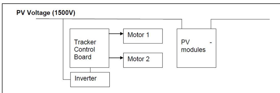
Figura 4: Alimentazione del motore dei tracker direttamente dal campo PV
