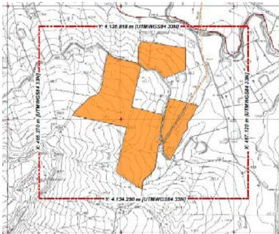
Figura 2: coordinate geografiche del perimetro racchiudente l'area di progetto fornite nel sistema di riferimento UTM WGS84 - stralcio dell'elaborato grafico "TAVA12a16 - Carta con localizzazione georeferenziata")
