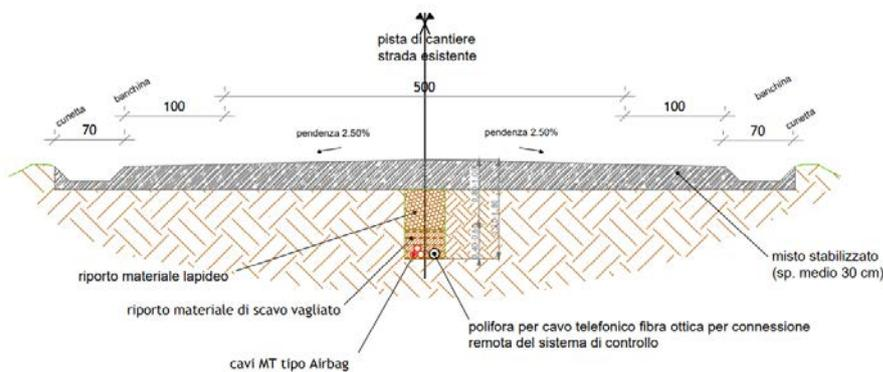
Figura 8: esempio di sezione tipo: Pista di cantiere con cavidotto interrato (in alto) e Passaggio di cavidotto su strada comunale esistente (in basso)
