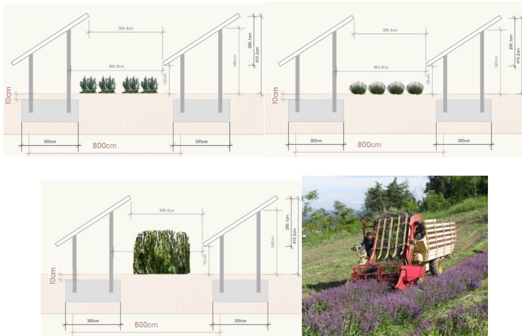
Figura 2-9: Sezione delle coltivazioni di rosmarino, lavanda e canapa tra i PF fissi e raccogliatrice compatta per piante officinali.
