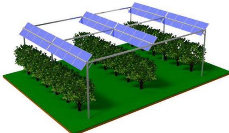
Figura 2-1: Struttura T01 Overhead Dynamics.
