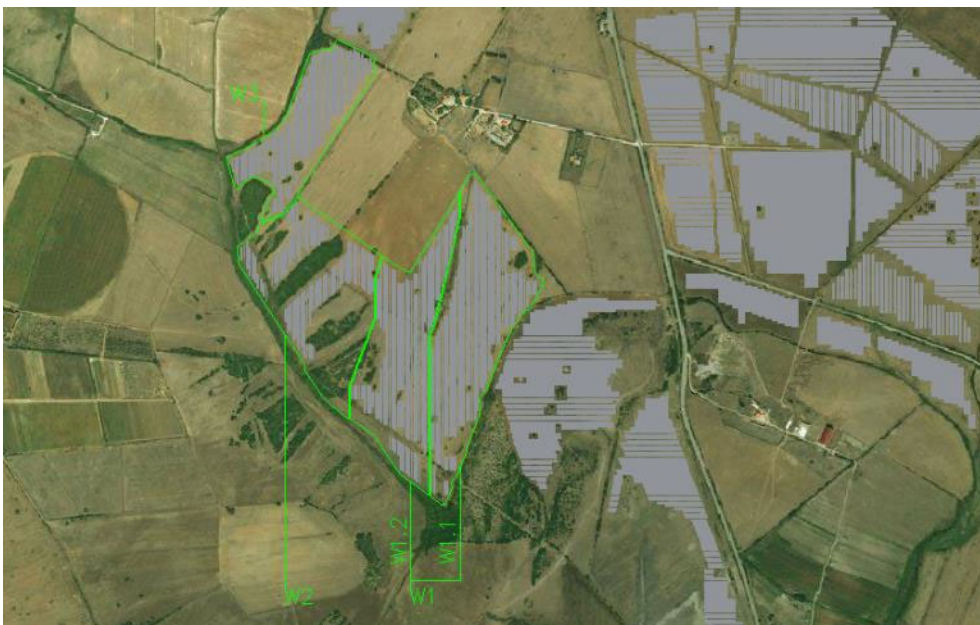
Figura 3-3 Suddivisione Impianto Fotovoltaico in sottocampi – Campo W
