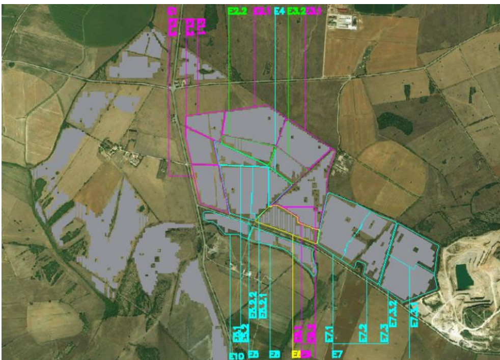
Figura 3-5 Suddivisione Impianto Fotovoltaico in sottocampi – Campo E
