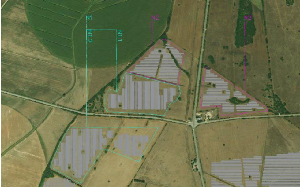
Figura 3-2 Suddivisione Impianto Fotovoltaico in sottocampi – Campo N
