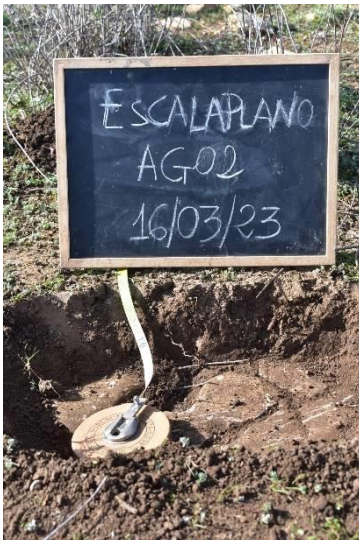
Figura 7 - Sito in cui è prevista l'installazione dell'aerogeneratore AG02 nel territorio di Escalaplano, in basso il profilo eseguito nel punto rilevato
