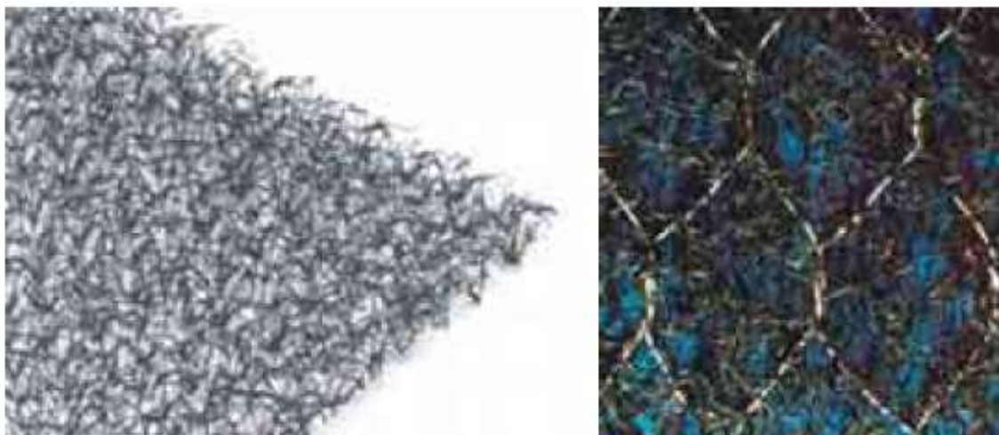
Figura 5 - A sinistra - geostuoia tridimensionale in fibre di polipropilene. A destra - georete tridimensionale rinforzata con una rete metallica a doppia torsione a maglie esagonali.
