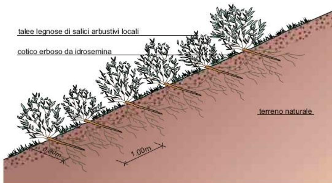
**Figura 7 - La sezione mostrala disposizione delle piante nella messa a dimora di talee. Il terreno deve consentire l'infissione per almeno 50-80 cm le talee debbono essere inclinate leggermente sull'orizzontale.**
