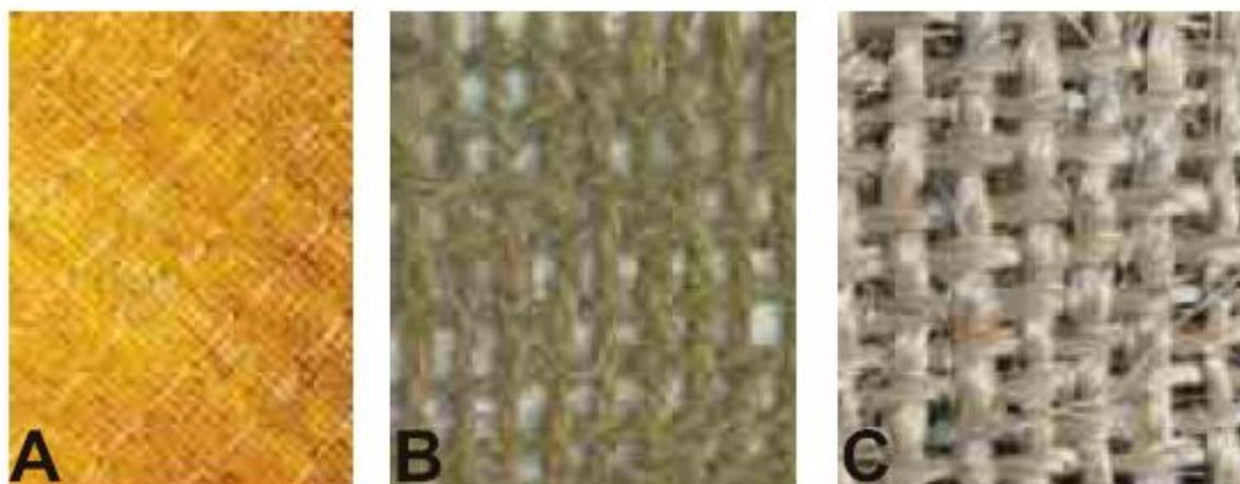
**Figura 7 - A) BIOSTUOIA IN FIBRE DI COCCO: LE FIBRE SONO INTRAPPOLATE TRA DUE RETINE POLIOLEFINICHE CHE HANNO LA DOPPIA FUNZIONE DI IMPEDIRE LA DISPERSIONE DEL COCCO E DI CONFERIRE MAGGIORE RESISTENZA MECCANICA AL GEOSINTETICO. GENERALMENTE LE RETINE SONO FOTODEGRADABILI, IN MODO DA SCOMPARIRE UNA VOLTA ESAURITASI LA FUNZIONE PROTETTIVA DELLA BIOSTUOIA.
