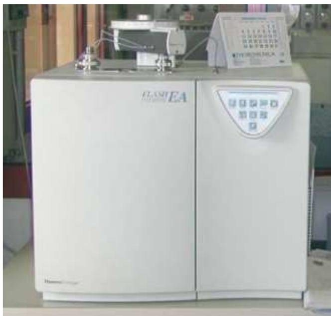
Analizzatore elementare di azoto
