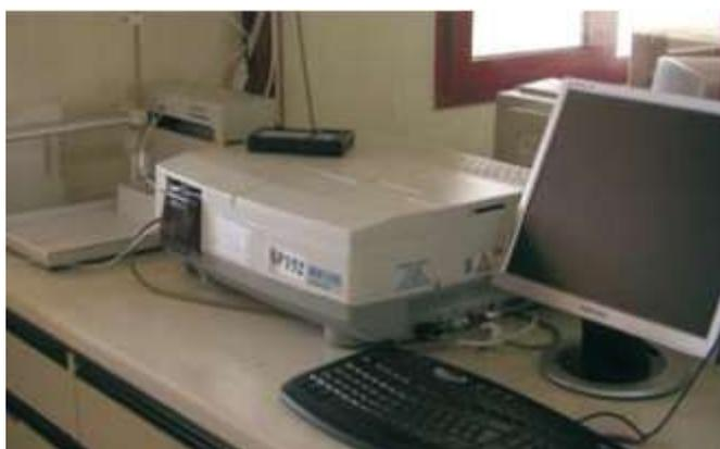
Spettrofotometro per l'analisi colorimetrica del fosforo assimilabile
