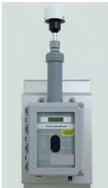
Sonda per le polveri sottili in atmosfera
