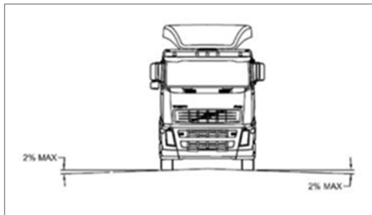
Figura 17. Illustrazioni prese dal “Wind farm Roads Requirements” della Siemens Gamesa, relative alla pendenza longitudinale (a) e alla pendenza laterale della carreggiata (b).
