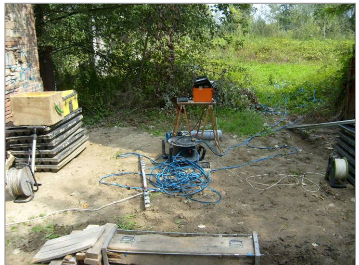
DH S01: Approntamento trave per energizzazione trasversale
