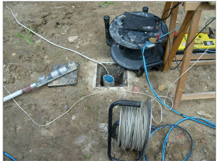
DH S01: Foro attrezzato con tubo per down hole
