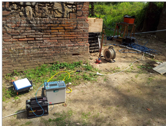
CH ERT: Collegamento agli elettrodi in S1
