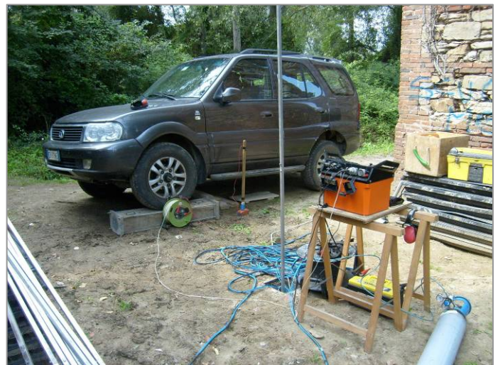
DH S01: Energizzazione trasversale, vista da Est
