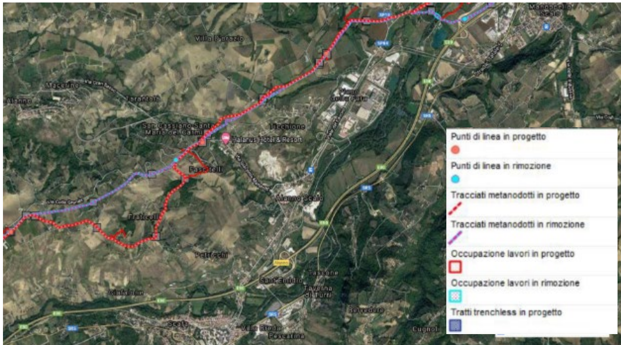
Figura 12 – Localizzazione dell’opera di rifacimento del metanodotto Chieti-Rieti.
