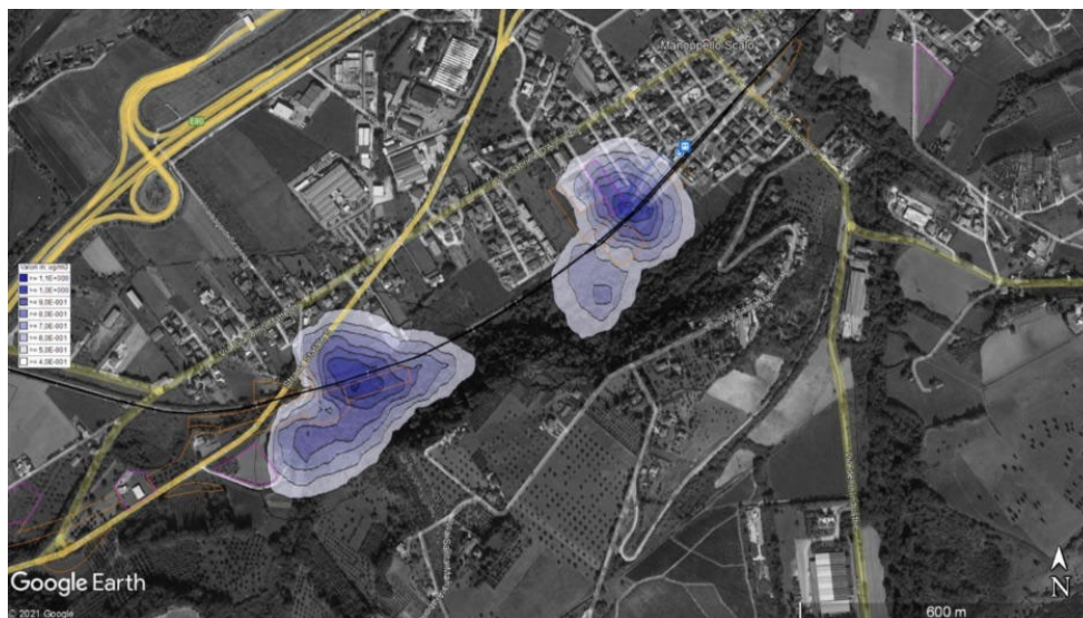
Figura 11 - Area di valutazione 2 (Lotto1) e area di valutazione 1 (Lotto 2). Concentrazioni di NO_x dovute alle emissioni dei mezzi d'opera.
