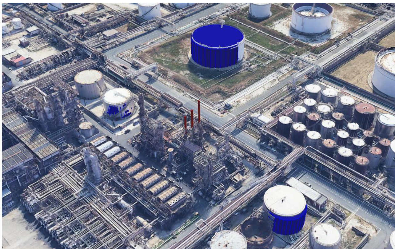
Figura 4-13: ricostruzione delle principali strutture per il calcolo dell'effetto building downwash nell'intorno delle sorgenti E9-E10-E11
