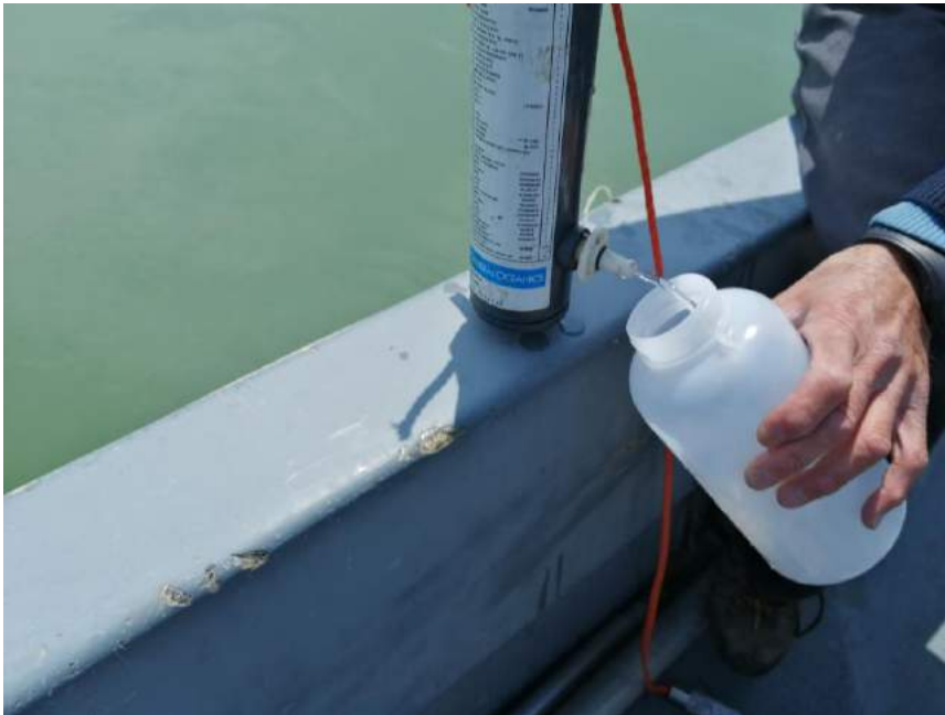
Figura 2-4 Prelievo di campioni d'acqua con bottiglia Niskin
