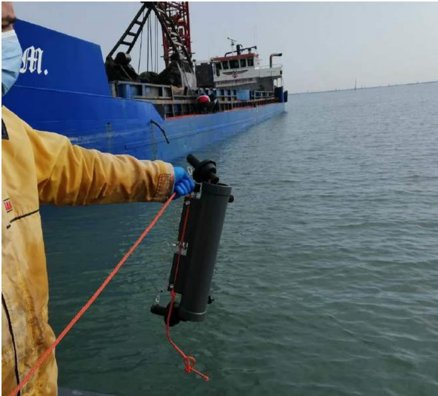
Figura 2-4 Prelievo di campioni d'acqua con bottiglia Niskin
