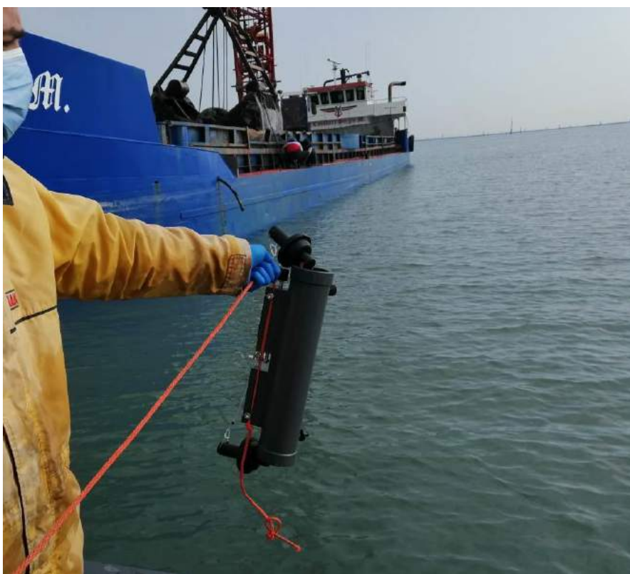
Figura 2-4 Prelievo di campioni d'acqua con bottiglia Niskin (foto d'archivio).
