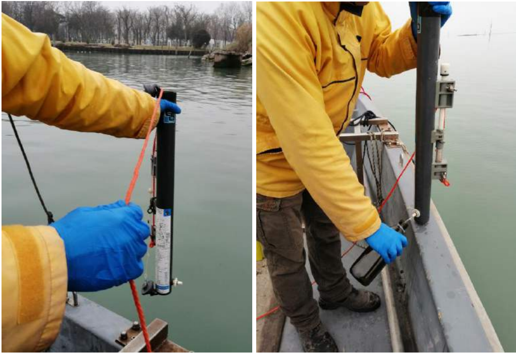
Figura 2-4 Prelievo di campioni d'acqua con bottiglia Niskin
