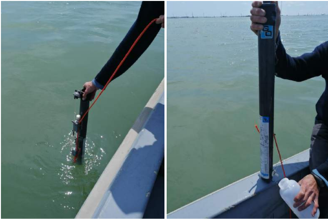
Figura 2-4 Prelievo di campioni d'acqua con bottiglia Niskin
