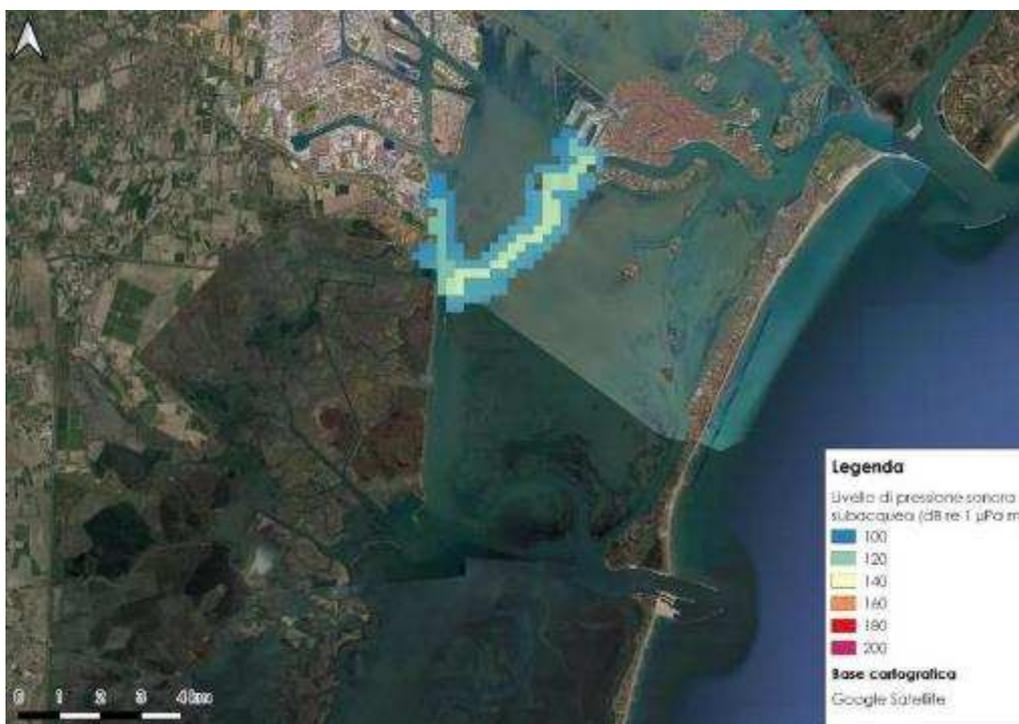
Figura 6.30: Livelli di pressione sonora subacquea nelle aree di interesse per il traffico nel Canale Contorta.
