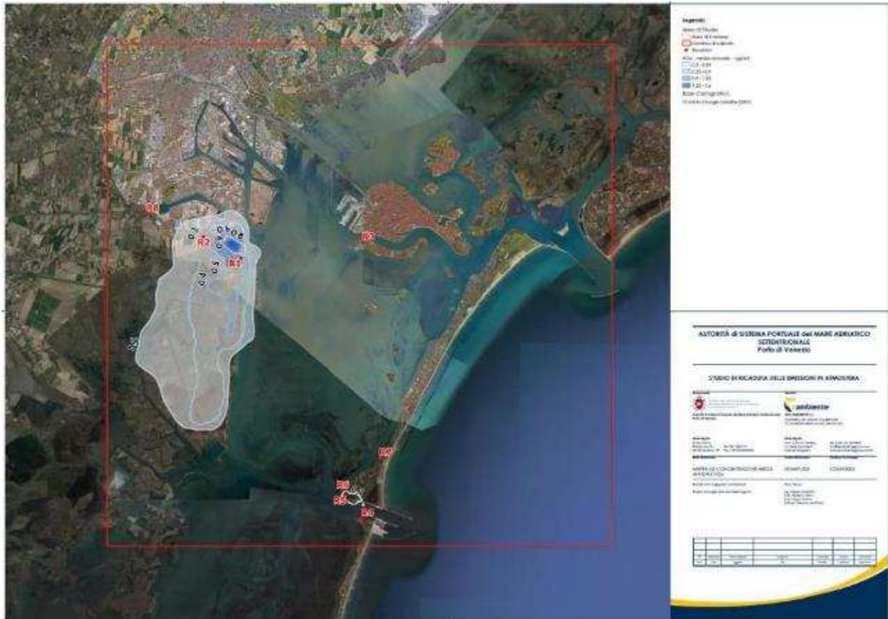
Figura 6.21: Concentrazione media annua di NO<sub>x</sub> nelle aree prossime a quelle di progetto dovute alle unità navali in transito.
