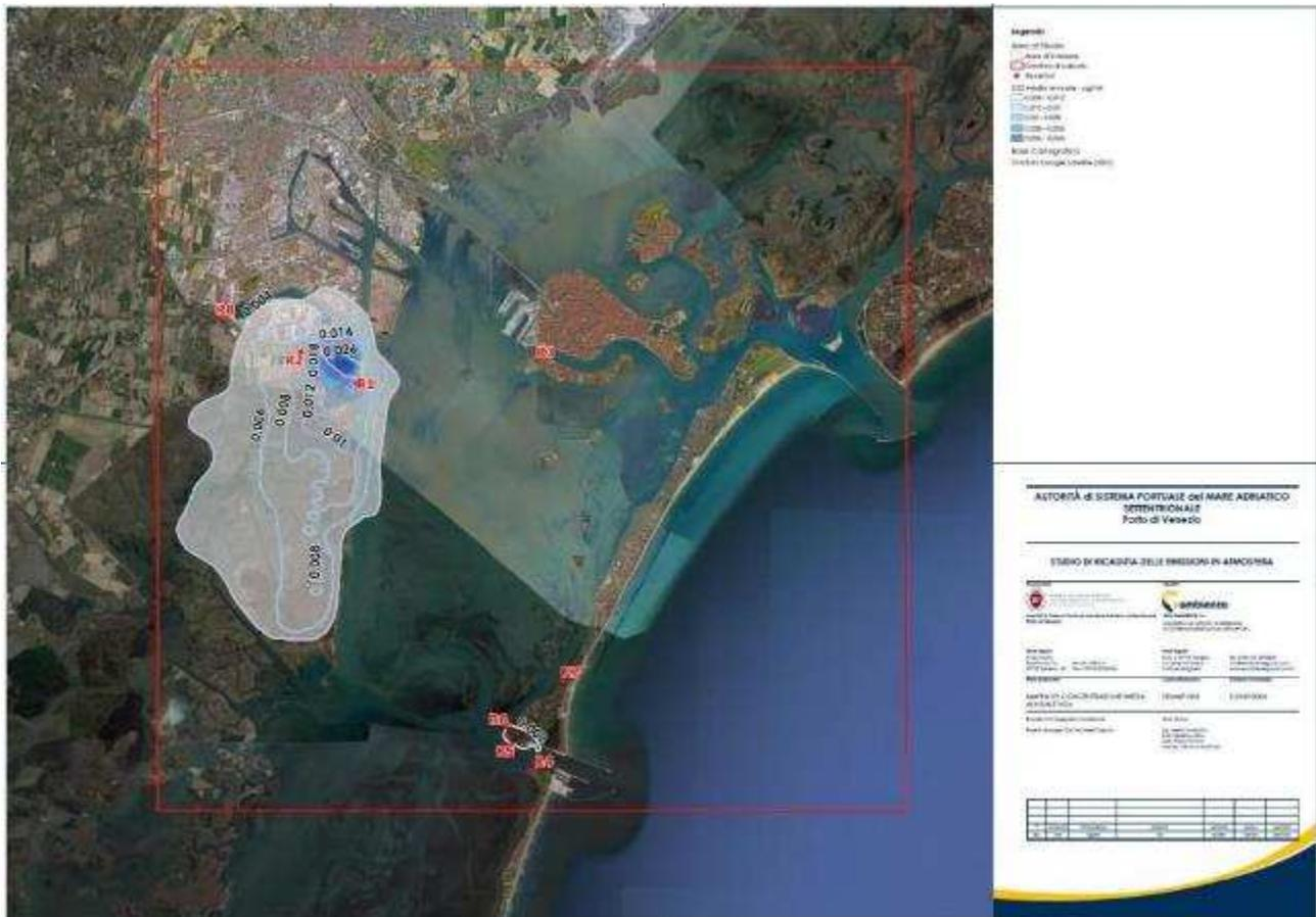
Figura 6.22: Concentrazione media annua di SO<sub>2</sub> nelle aree prossime a quelle di progetto dovute alle unità navali in transito.
