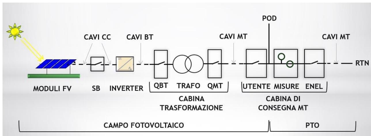
L'impianto FV ha la capacità di generare energia elettrica dai Moduli FV: ogni singolo Modulo FV trasforma l'irraggiamento solare in energia elettrica, generata in forma di corrente continua.
