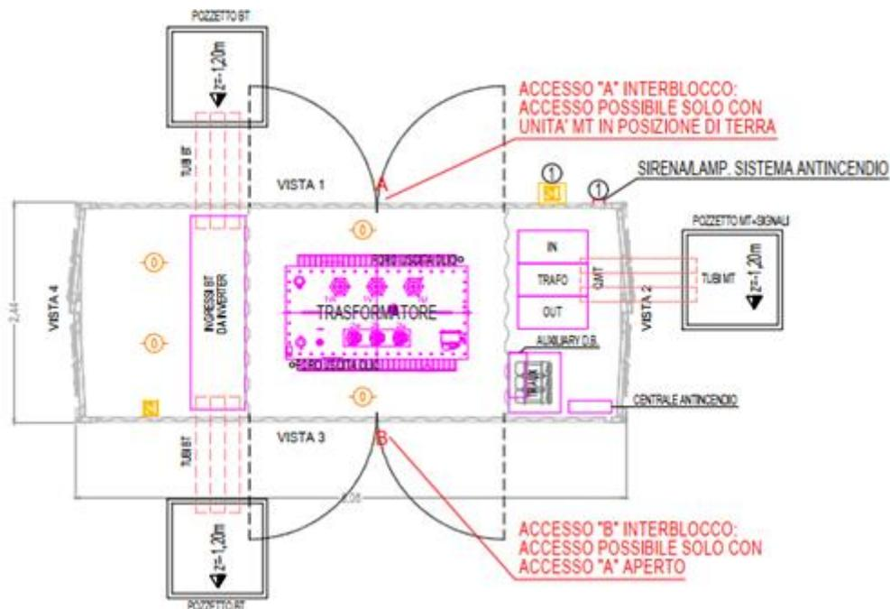
Figura 6 - Layout preliminare cabina di trasformazione BT/MT
