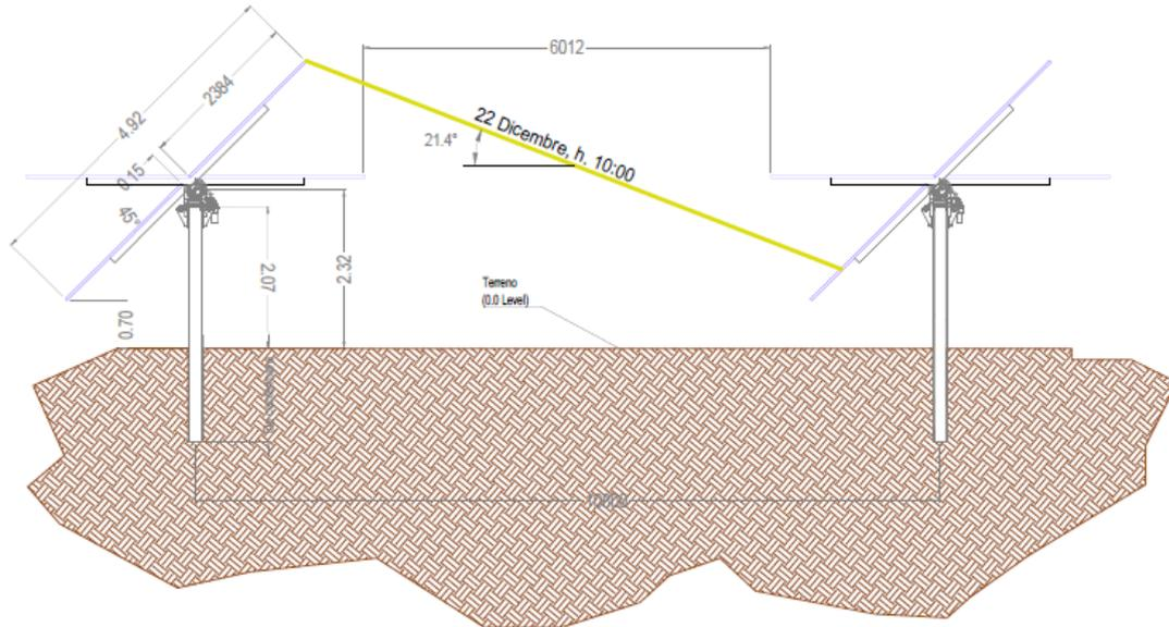
Figura 4 - Inseguitori mono-assiali: modalità di installazione e principali quotature
