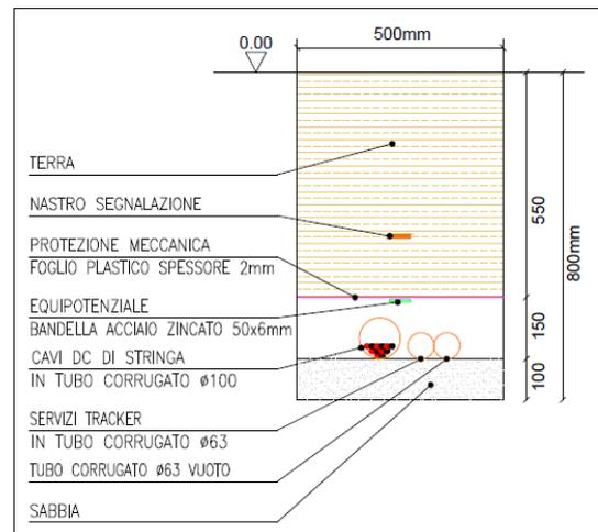
La sezione tipica di questi cavidotti è essenzialmente costituita da una sezione larga 500mm e profonda 800mm, che sarà riempita con:
