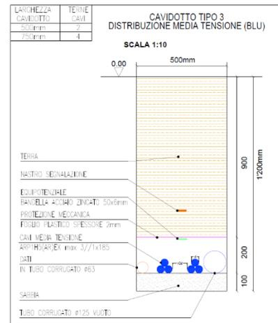
La sezione tipica di questi cavidotti è essenzialmente costituita da una sezione larga da 500 a 750mm (a seconda del numero di cavi MT da posizionare) e profonda 1'200mm, che sarà riempita con:
