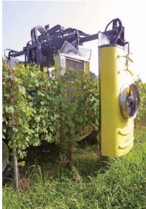
Foto 2 - pompa irroratrice a polverizzazione pneumatica con diffusore anti-deriva
