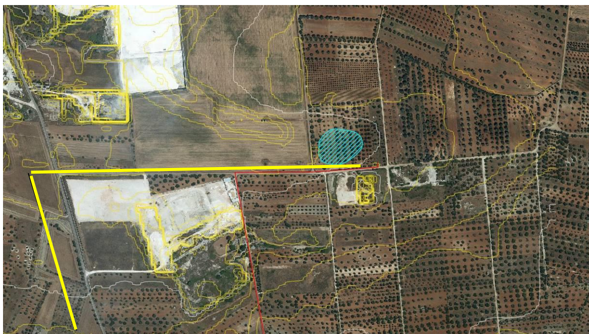
Fig. 5.6 - Morfologia dell'area terminale del cavidotto con evidenza delle curve di livello e della presunta area endoreica.
