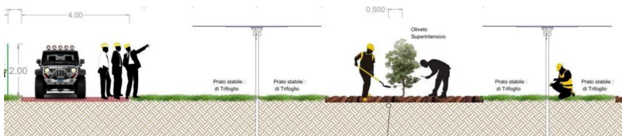
Fig. 3.2 – Schema di progetto – Filari di generatori FV alternati a filari di olivo superintensivo
