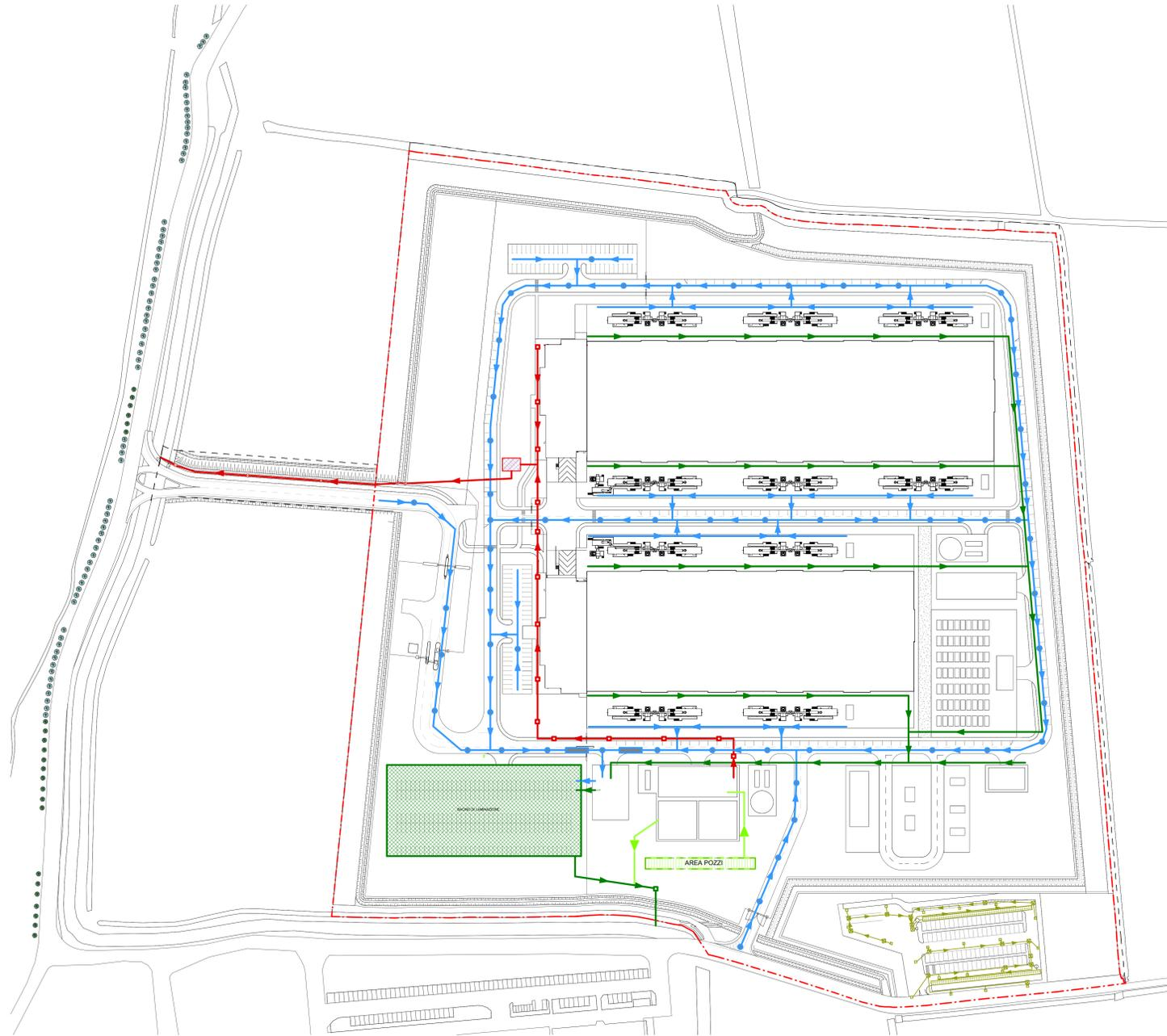
**1 SCHEMA DI DRENAGGIO E SCARICO**
