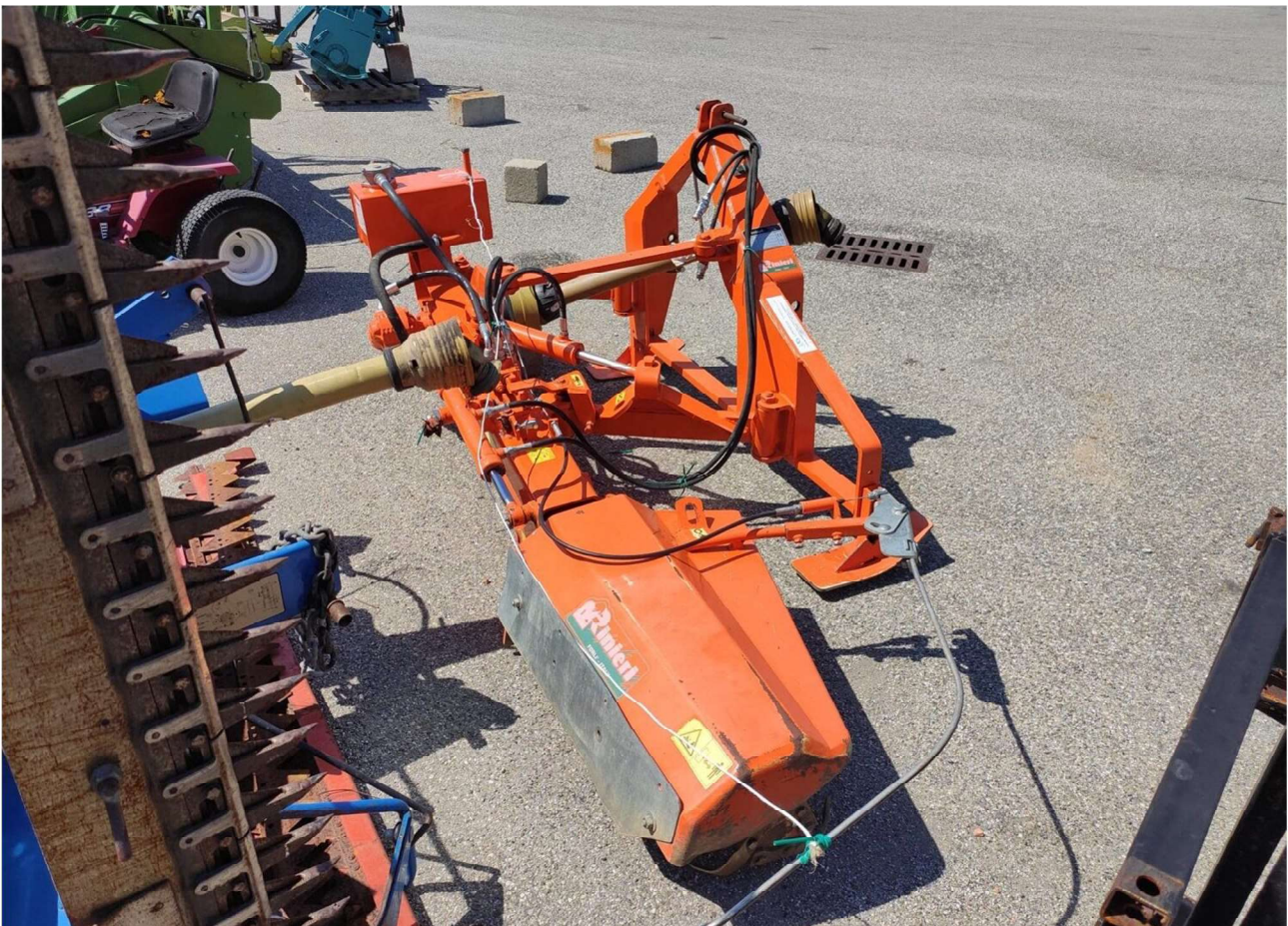
(Fresatrice intercoppo. In primo piano il dispositivo che fa evitare all'attrezzo di urtare i sostegni delle stringhe)
