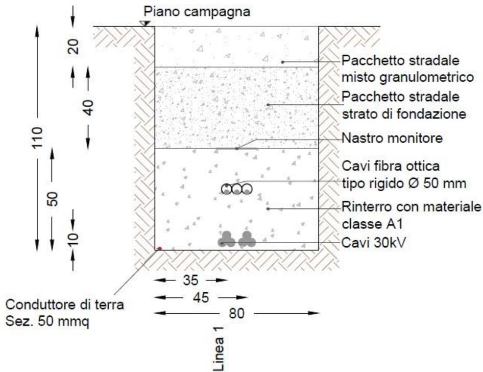
(Sezione tipo di scavo su strade sterrate)
