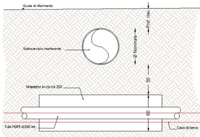
(Sezione trasversale e longitudinale attraversamento sottopasso)
