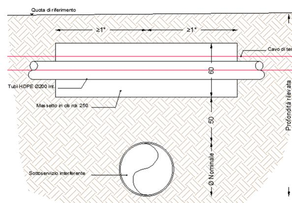
(Sezione trasversale e longitudinale attraversamento sovrappasso)
