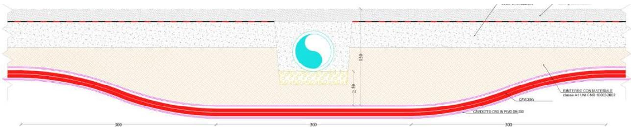
(Attraversamento idraulico con metodo spingitubo)
