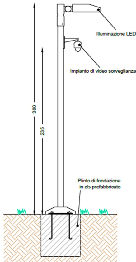
(Dettaglio tipico di integrazione tra illuminazione e sistema di videosorveglianza)
