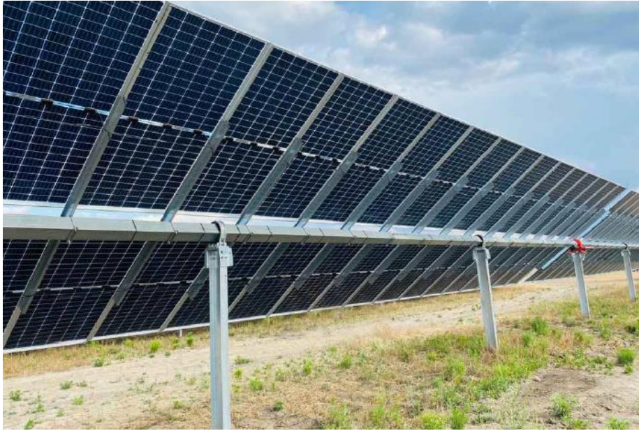
(Esempio di tracker monoassiale montante moduli bifacciali: si scorge in rosso il motore per l'inseguimento solare)
