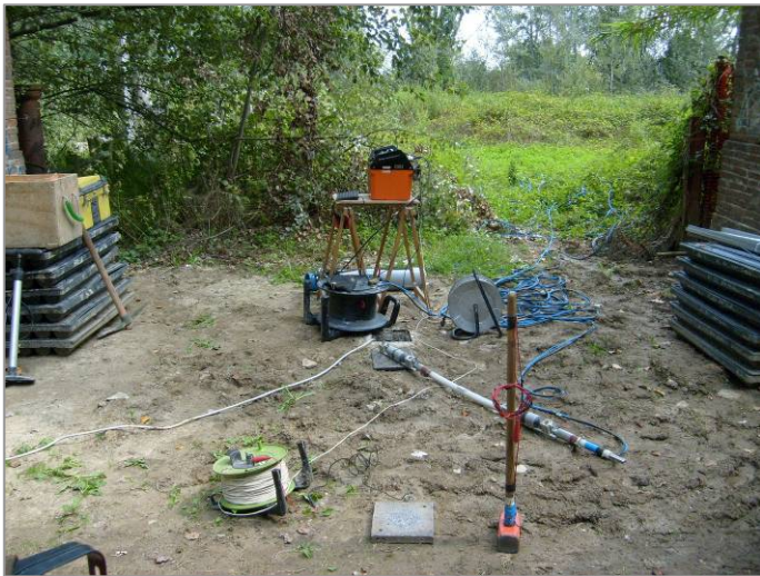
DH S01: Energizzazione verticale, vista da Ovest
