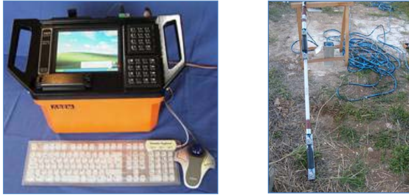
Figura 3.2.1 - A sinistra sismografo "ABEM Instrument AB" modello Terraloc MK8. A destra geofono da foro "AMBROGEO".
