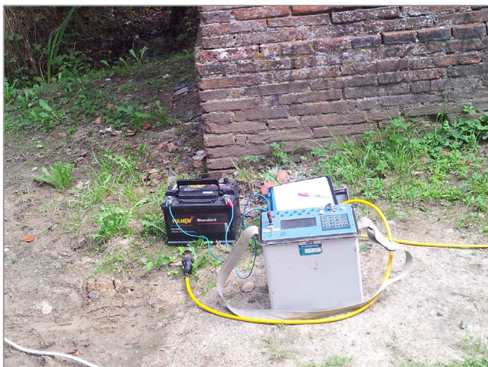
CH ERT: Postazione georesistivimetro IRIS Syscal
