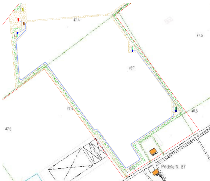
Figura 23: Tracciato linee MT impianto 1
