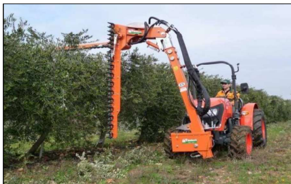
Figura 15 - Esempio di potatrice meccanica frontale a doppia barra (taglio verticale + topping) utilizzabile su tutti le colture arboree intensive e superintensive
