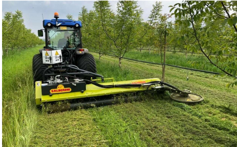
Figura 9 - Falciacondizionatrice con sensori interfilari
