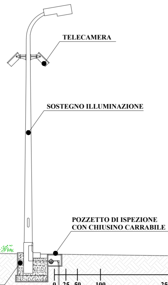
PARTICOLARE PALO ILLUMUNAZIONE PERIMETRALE E VIDEOSORVEGLIANZA - SCALA 1:50
