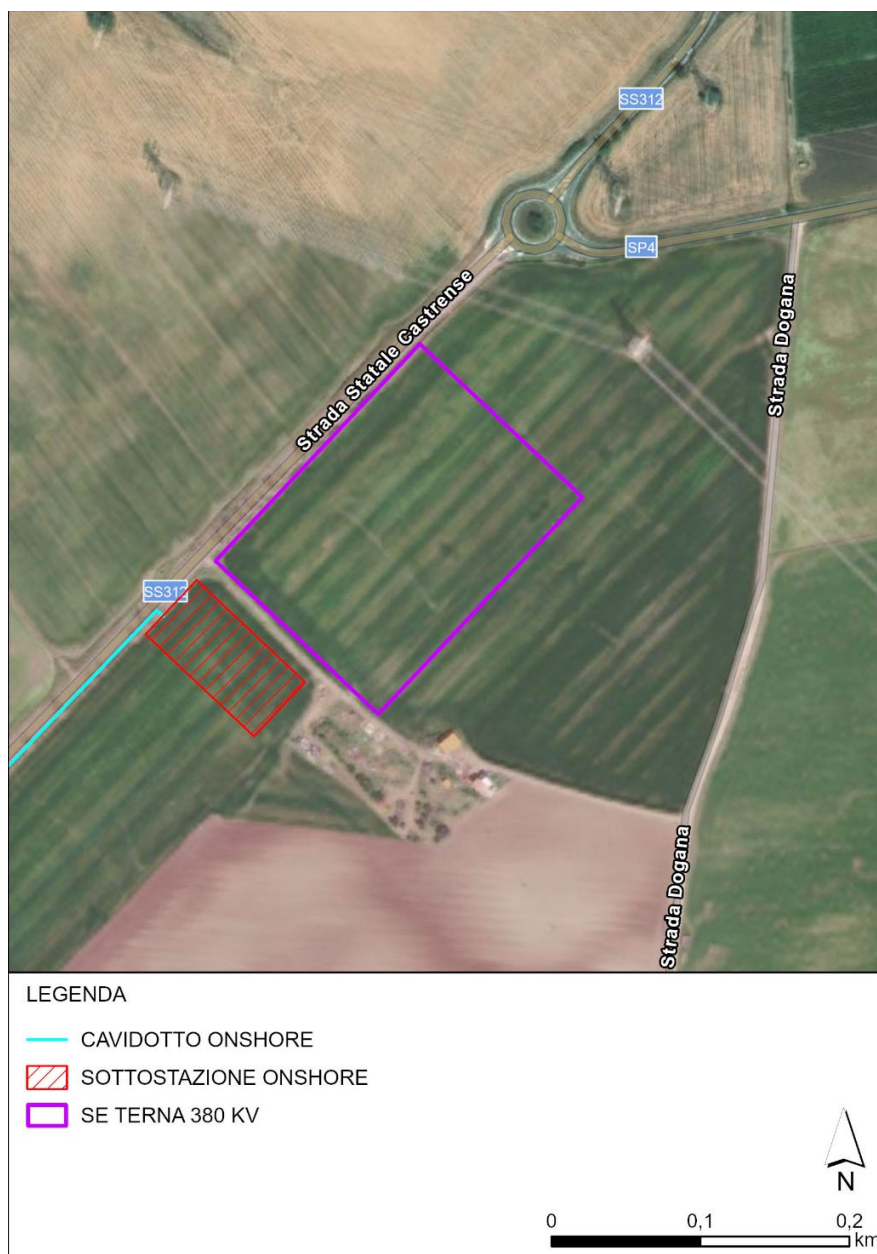
Figura 2.21 Proposta preliminare per l'ubicazione della sottostazione onshore
