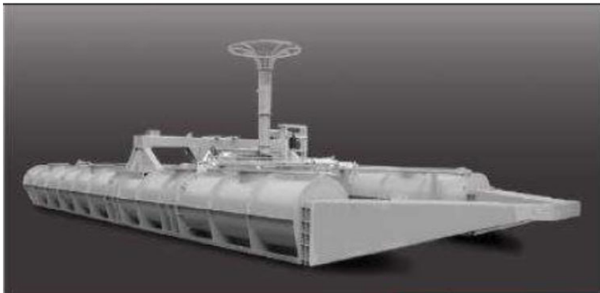
Figura 2.13 Esempio di macchina per il “trenching” a galleggiamento controllato.
