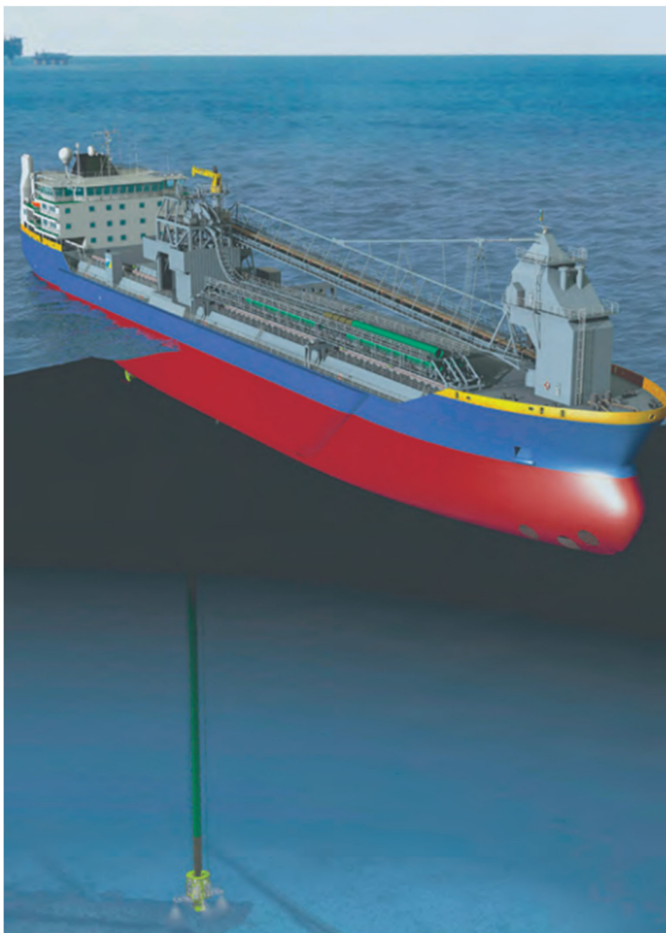
Figura 2.14 Esempio di nave equipaggiata con macchina per l'esecuzione di protezione mediante "rock dumping"
