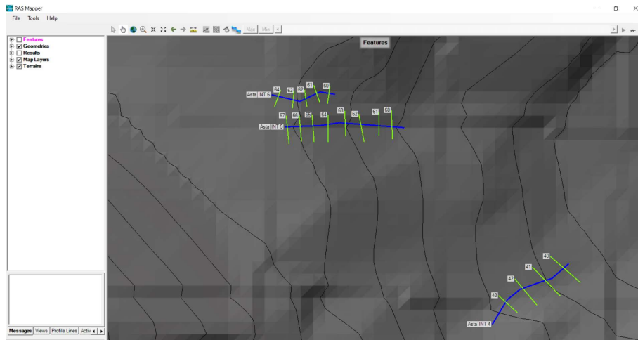
Figura 14 Schematizzazione idraulica con il software HEC-RAS delle aste INT4, INT5, e INT6
