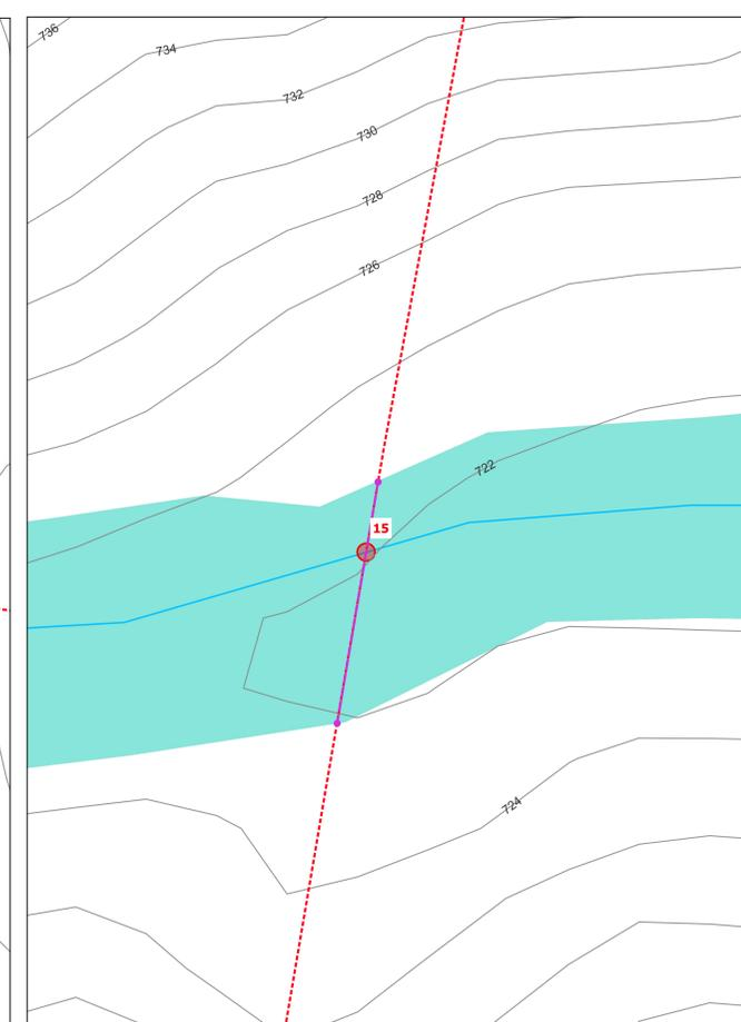
RISOLUZIONE INTERFERENZA CAVIDOTTO - OPERA IDRAULICA MEDIANTE TRIVELLAZIONE ORIZZONTALE CONTROLLATA (INERFERENZE N. 1 - 2 - 3 - 4 - 9 - 10 - 11 - 12 - 13)
