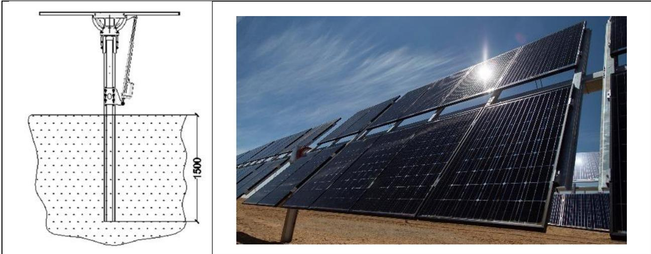
**Figura 7** Tracker particolari - Palo infisso nel terreno mediante macchina battipalo
