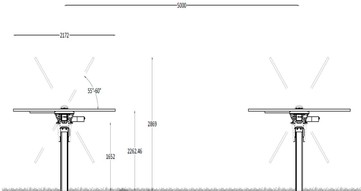
**Figura 2:** Immagine illustrante le dimensioni caratteristiche dell'impianto.
