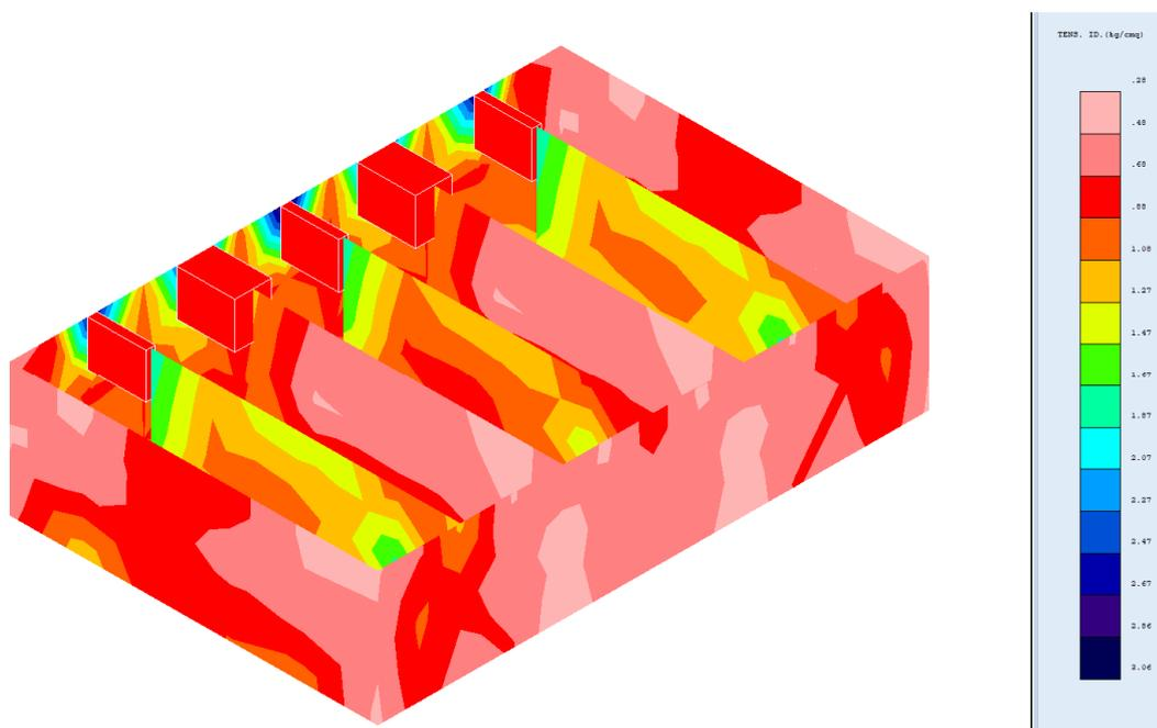
FIG. 15: Stato Tensionale Ideale
