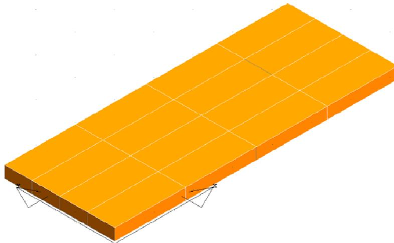
Le pressioni sul terreno derivano dalle azioni agenti sulla struttura fattorizzate con i coefficienti A1 secondo la combinazione:
