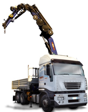
Autogru per sollevamento strutture prefabbricate
